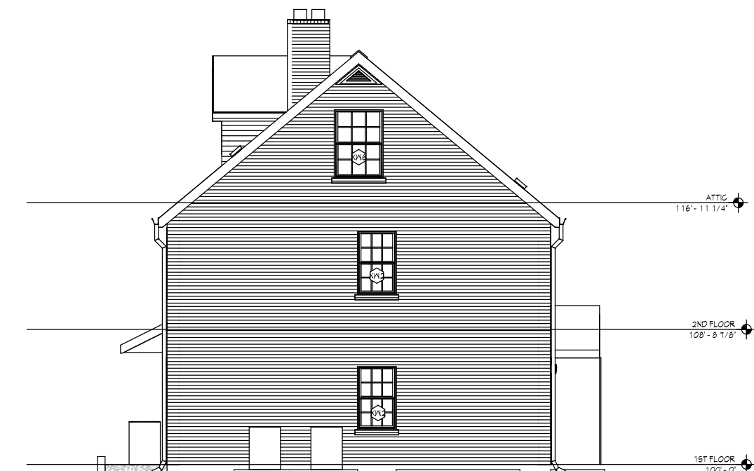
B A201.f BLDG 'F' SIDE 1 ELEVATION 1/4" = 1'40"
